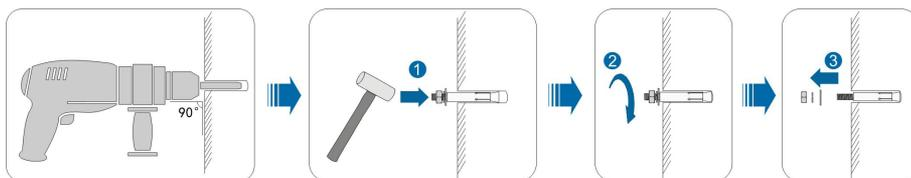
**步骤4** 使用膨胀螺栓固定挂板。
