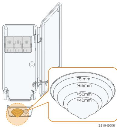
**步骤5** 将去除保护层的线缆穿过密封圈，固定底部封板的螺丝。
