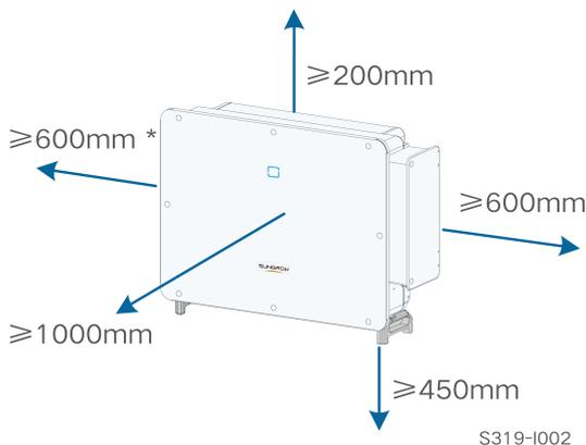
\*当此距离小于图中距离时，在进行风扇维护操作之前，需要先将逆变器抬离支架或墙面。
