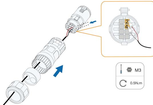
步骤6 向后轻轻拉动线缆，顺时针拧紧锁紧螺母。
