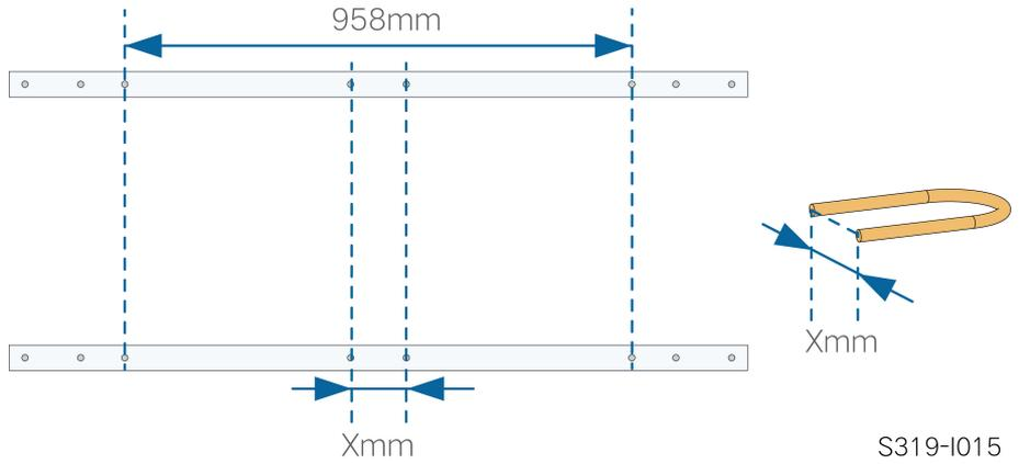
**步骤4** 使用螺栓及卡箍将U型钢固定至立柱。
