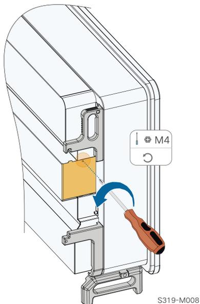
**步骤3** 按下风扇电源接头上的突起并向外拨开，松开风扇架上的螺钉。
