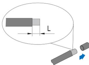
**步骤2** 利用压线钳将电缆线端集束在接线端子。
