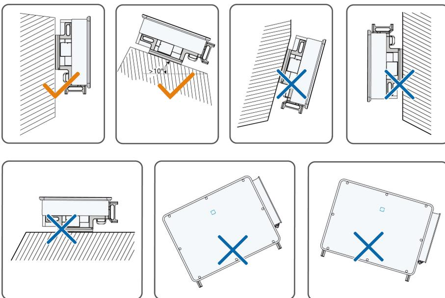
如果安装地点为水平的地面等场景时，应当将逆变器安装到支架上以满足安装角度要求。支架及逆变器完成安装后的示意图如下所示。
