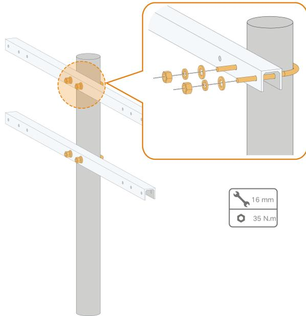
**步骤5** 使用螺栓将挂板固定至U型钢。
