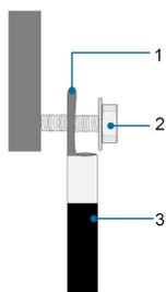
图 5-2 铝制导线端子连接顺序
