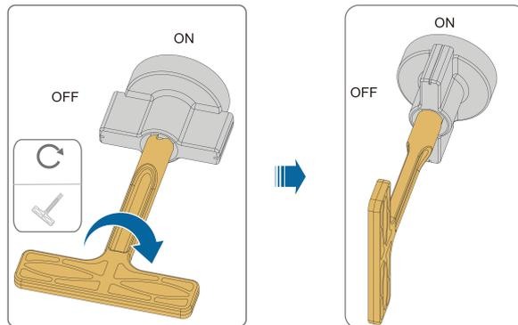
图 8-1 智能隔离开关复位示意图
