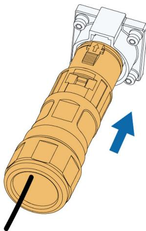
步骤9 使用防水塞封堵空置的连接器密封圈。
