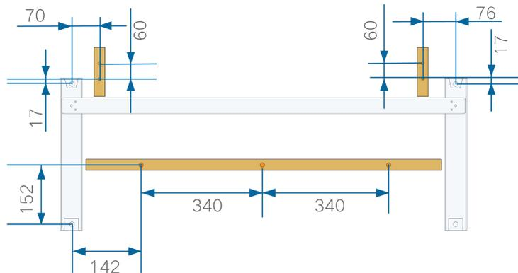
图 4-3 挡板和挂板的相对距离 (单位mm)
