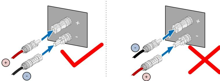
步骤4 将其他光伏组串按照步骤2和步骤3进行连接。
