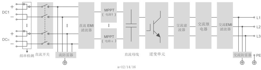
图 2-4 电路结构框图
