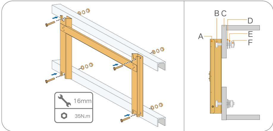
(A)挂板 (B)全螺纹螺栓 (C)金属支架 (D)平垫片 (E)弹簧垫片 (F)六角螺母
