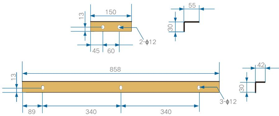
图 4-2 挡板尺寸 (单位mm)
