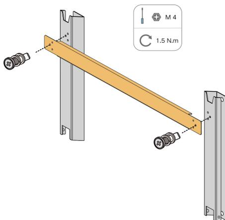
**步骤2** 将组装好的挂板置于光伏支架上。使用水平尺调整角度，标记打孔位置。使用电钻打孔。
