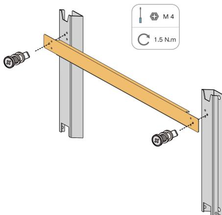
**步骤2** 将组装好的挂板置于安装点，使用水平尺调整角度，标记打孔位置。
