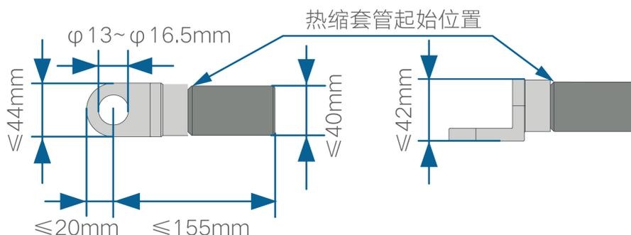
图 5-3 端子压接后尺寸
