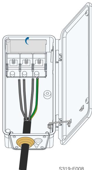
**步骤7** 制作线缆，压接OT/DT 端子。固定线缆至对应的端子，端子的安装扭矩请参考交流盒内的扭矩标签。
