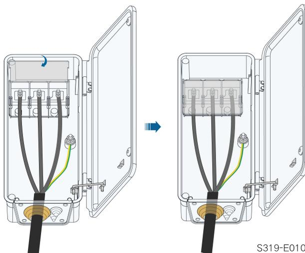
**步骤9** 取下连接杆，放置在原位。关闭接线盒，用提供的内六角扳手拧紧其前盖上的两个螺丝。
